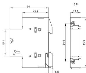
\* Ideali per l'utilizzo negli impianti fotovoltaici\* Portafusibili per fusibili cilindrici serie gPV\* Idonei per impianti a 1000V
