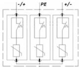
Limitatore di sovratensione DC, tipo II, tensione nominale: 1000 V
