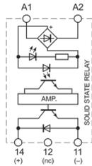
1 relè optoisolato 12-24Vdc mosfet 5A a vite, estraibile
